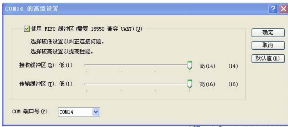
点击 COM 端口号右边的向下键头, 选择 COM1~COM4 之间的端口, 一般会跳出一问你是否强行修改的窗口, 点击确认就可以了, 如下图
