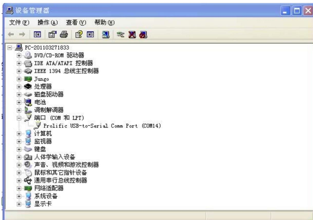
大家看到, 电脑上面显示了一个 COM14, 这就是插上仿真器安装好驱动后显示的端口, 但这个 COM14 端口号太大了, 要修改到 COM1~COM4 之间, 因为 AVR STUDIO 软件只识别 COM1~COM4, 大于 COM4 就不识别了, 所以在此我们要修改一下端口标号, 右键点击端 COM14 端口的属性, 显示如下:
