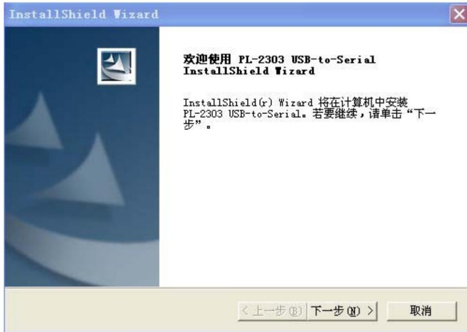
再点击下一步,直到完成,即安装完成仿真器的 XP 驱动,在此提醒一下大家,安装驱动时要确保仿真器没有插到电脑上面哦,还有相关的外插设备也要拔掉,如果安装仿真器驱动时,仿真器插到了电脑上面或者有外接相关设备(主要指 USB 转串口设备,可能软件有冲突)在上面,那就需要重新安装驱动了,重新安装驱动大家要注意几个步聚了(目的是先移除前面安装的驱动再重新启动电脑,再安装驱动),如下:
