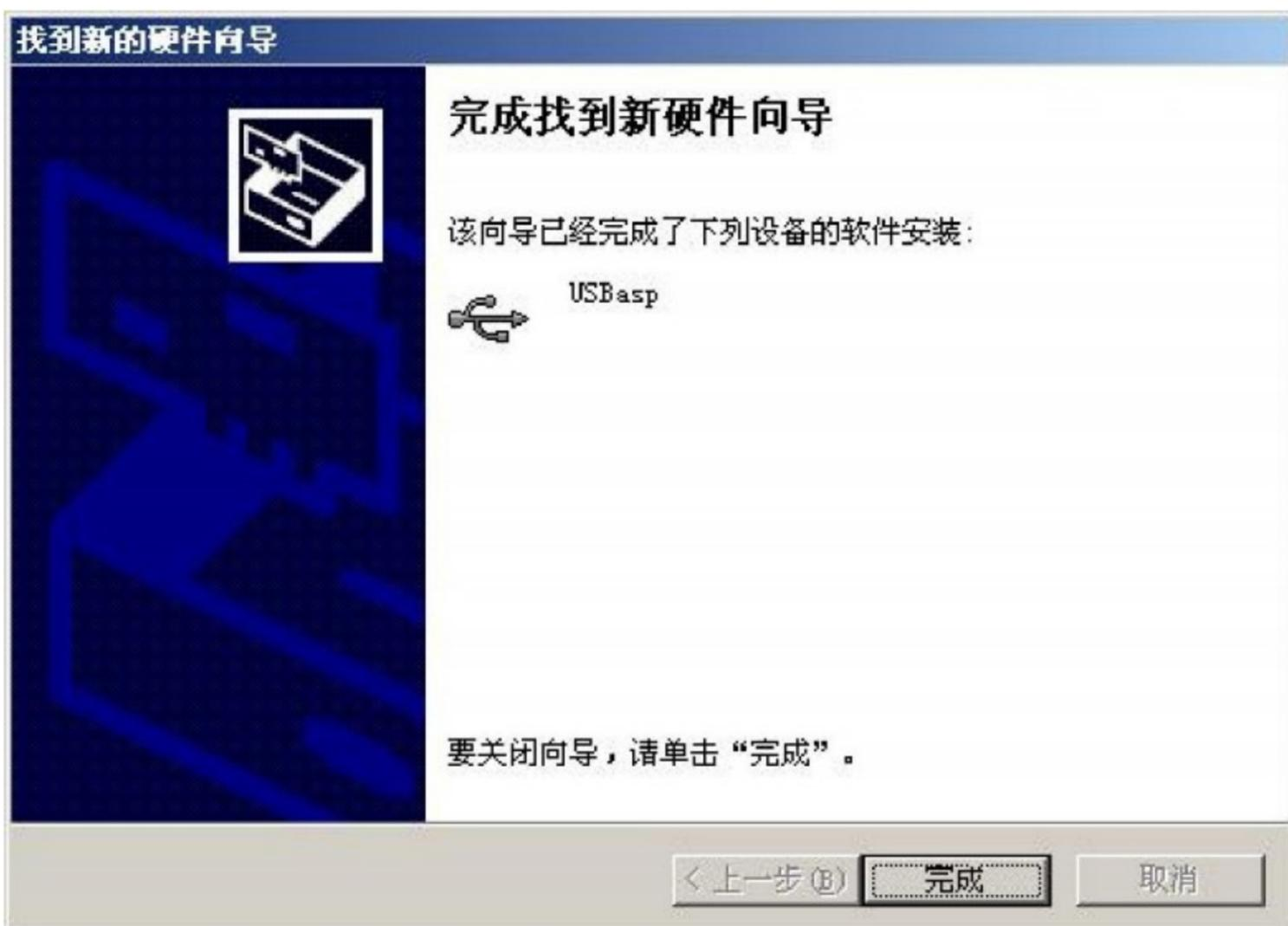
安装成功后，在设备管理器中应该能发现下面的 USBasp 硬件
